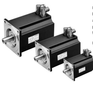
Les servomoteurs brushless série SMB répondent aux exigences de hautes performances grâce à la technologie à pôles saillants et aux aimants Néodyme Fer Bore pour hautes températures. Rapport poids / puissances très avantageux, rotors à faibles inerties favorisant une haute dynamique.
